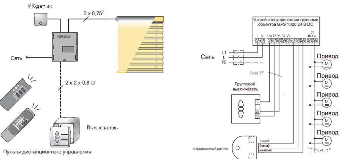
12. Проверить правильность подключения изделия, для чего нажать кнопку «ВВЕРХ» выключателя (пульта). Если ламели изделия не пришли в движение необходимо поменять полярность на входе двигателя, поменяв местами питающие провода в разъёме.
